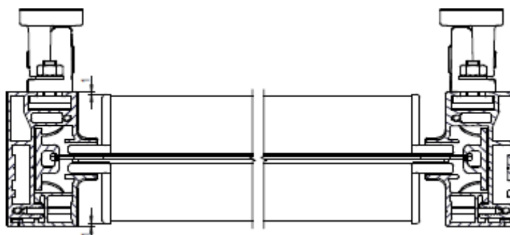
Rys. 24C Montaż przewodnic systemu Ziiip120 z użyciem uchwytów
